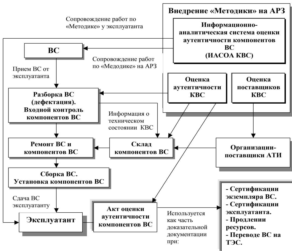
Рис. 7. Работы по оценке аутентичности компонентов ВС при проведении ремонта ВС
